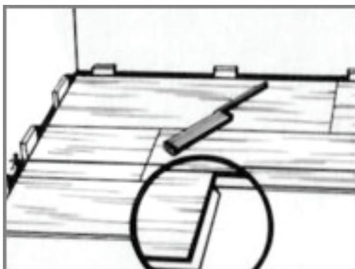
Jede neue Reihe mit dem Reststück (mind.40cm Länge) der vorhergehenden Reihe beginnen. Paneele der Länge nach gemäß der Markierung zusägen.
