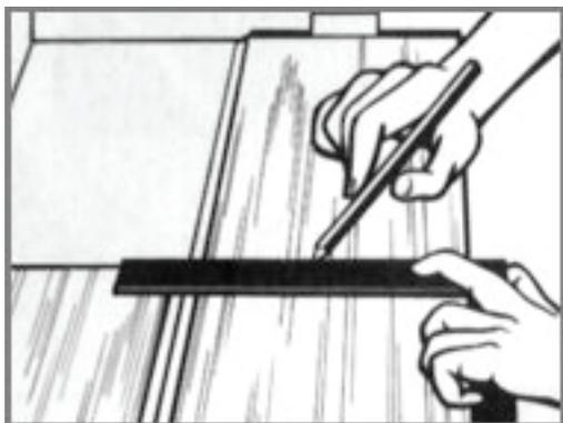
Letztes Paneel in der Reihe zum zuschneiden um 180° drehen mit Dekorseite nach oben neben bereits vorhandene Reihe legen (Feder an Feder). An der Stirnseite Wandabstand berücksichtigen. Paneel markieren und absägen.
