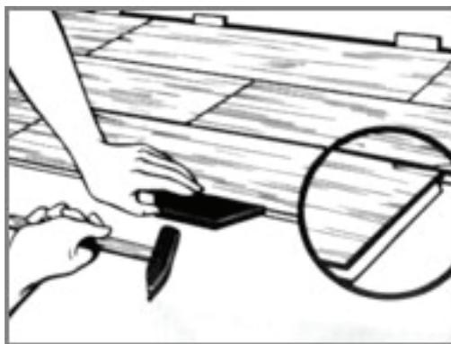
Paneele vorsichtig mit Hammer und Schlagklotz zusammenfügen. Zuerst die Längskante flachliegend ineinander fügen. Danach die Querstöße schließen. Bringen Sie die Paneele vor dem Zusammenfügen möglichst nahe an die endgültige Position.
