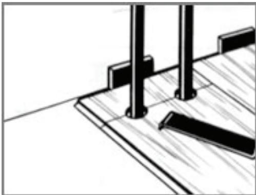
Das abgesägte Stück hinter den Heizungsrohren wieder dicht (mit Zugeisen) zusammenfügen.
