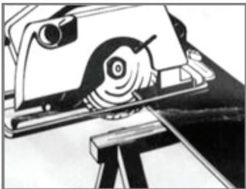
Immer von der Paneeloberseite sägen (Vermeidung von Kantenabsplitterungen) - nur bei einer elektrischen Stich- oder Handkreissäge muss die Dekorseite nach unten zeigen.
